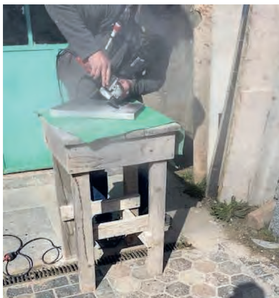
Utilisation de la disqueuse pour réaliser un arrondi sur la plaque
